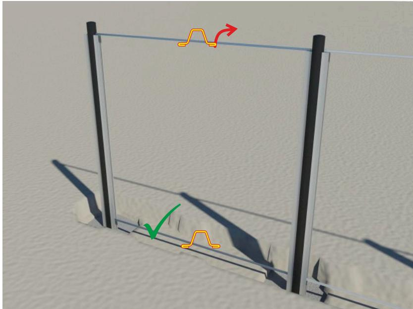
Na uitharden beton, bovenste verstevigingsprofiel + govaclips verwijderen (niet onderste).
