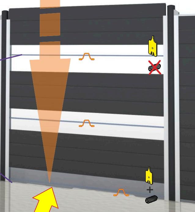
Het onderste profiel moet volledig ondersteund zijn door een stabiele ondergrond, die niet kan verzakken. (bv zandcement).
