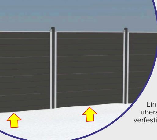
Het onderste profiel moet volledig ondersteund zijn door een stabiele ondergrond, die niet kan verzakken. (bv zandcement).
