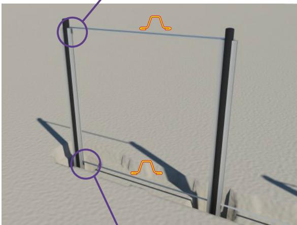
Verstevigingsprofiel onder en boven voor correcte afstand tussen 2 palen.
